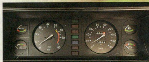
Přístrojový štít obsahuje dvojici kruhových ukazatelů, otáčkoměr býval u modelu VAZ 2107 samozřejmostí
